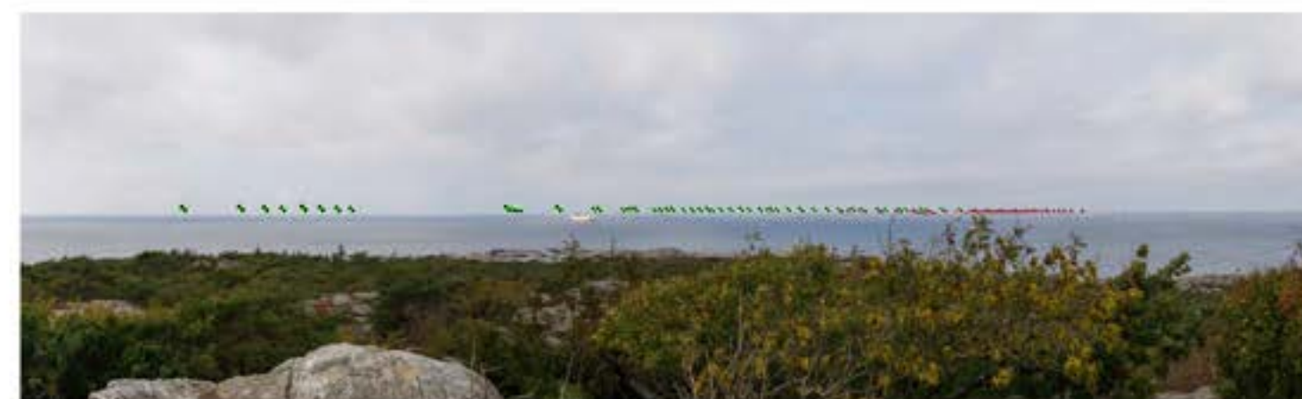
Symboler som visar vindkraftverkens placering. Avstånd till närmsta vindkraftverk är för Mareld: 53.5 km och Poseidon: 26 km
